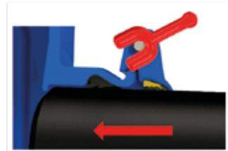
3. Insérer le tuyau jusqu'à la butée
