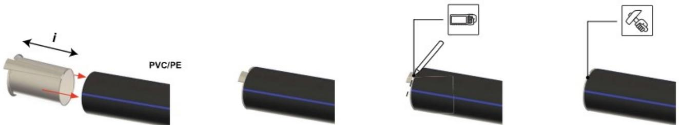
Vérifier que la bague soit appropriée au diamètre intérieur du tube.
